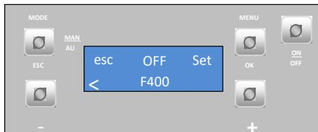
Cuando el silo se quede sin pellets, el sensor envía una señal y surge una alarma en la pantalla de la caldera (código A15). Debe llenar el silo de pellets, hacer reset a la alarma y reiniciar la caldera.
