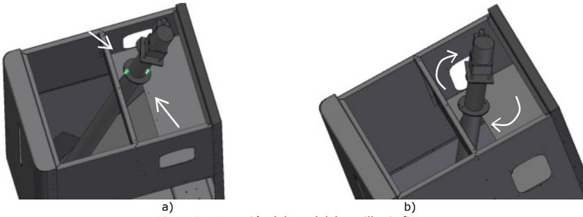
**Figura 34 – Rotación del canal del tornillo sin fin.**
