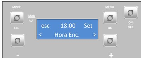
Para seleccionar la **hora de parada** en el programa P1, pulse “Set” y comenzará a parpadear. A continuación, pulse la tecla “+” o “-” para seleccionar la hora deseada y pulse “OK” para confirmar el valor. Pulse la tecla “+” para pasar al menú “P1 Temp. Aire”.
