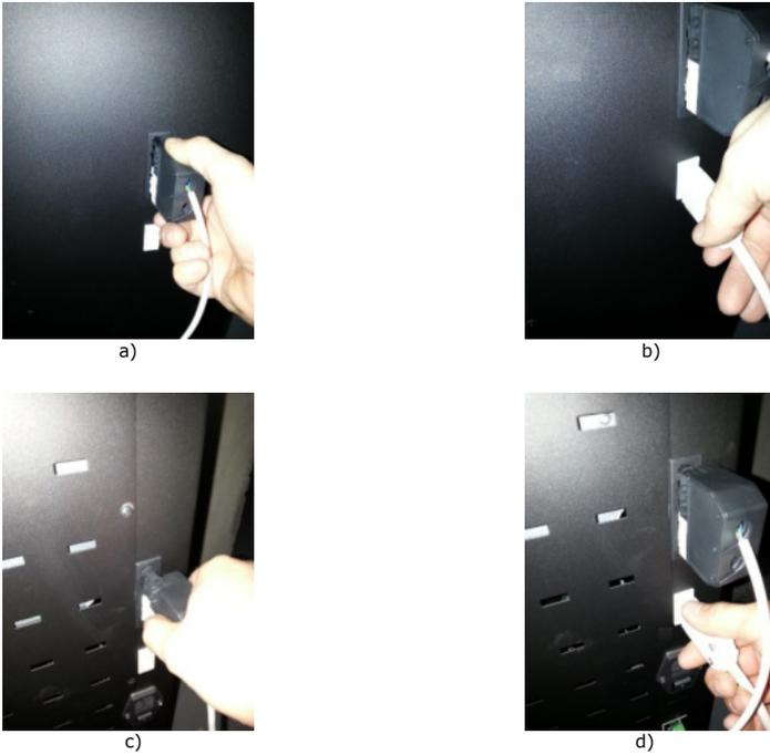
**Figura 41 – Conexión del sensor a la placa electrónica**
