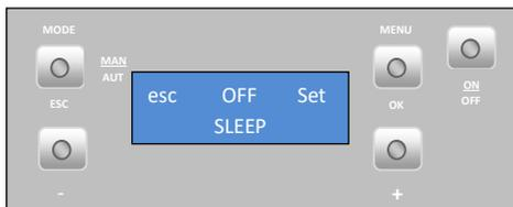
Pulse "Set" y comenzará a parpadear la hora. Mediante las teclas "-" y "+", puede escoger la hora deseada. Después de escoger la hora, pulse "OK" para confirmar. Pulse "esc" para volver al menú y "+" para avanzar al menú "Info".
