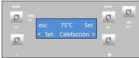
**Nota:** la temperatura del agua puede ser regulada por el usuario (temperatura de set-point del agua) entre 50 y 80 ° C.
