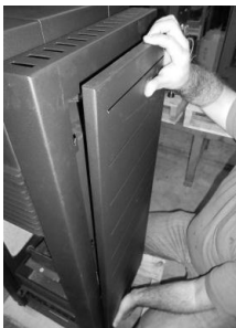
Figura 23 - Remoção das capas laterais
