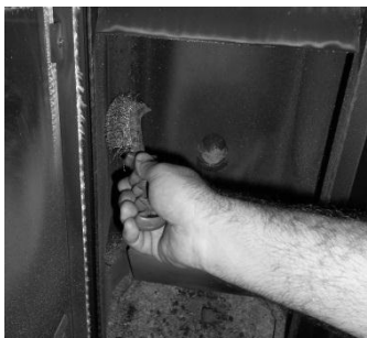
Figura 34 - Limpeza do interior da salamandra a água
