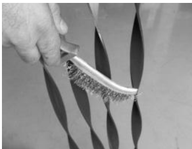
Figura 41 - Limpeza dos canais de passagem de ar e turbuladores
