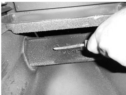
Figura 34 - Limpeza do interior da salamandra a água
