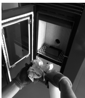
Figura 45 - Limpeza do vidro: a) aplicar líquido no pano; b) limpar o vidro com o pano
