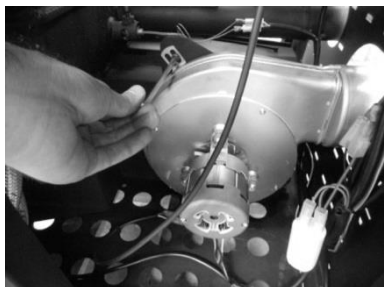
Figura 42 - a) Retirar os parafusos; b) Retirar extractor
