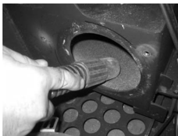
Figura 43 - Aspirar a zona de passagem do ar
