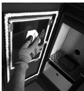
Figura 45 - Limpeza do vidro: a) aplicar líquido no pano; b) limpar o vidro com o pano
