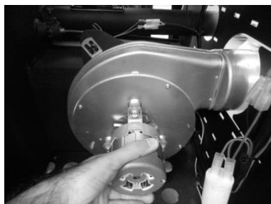
Figura 42 - a) Retirar os parafusos; b) Retirar extractor
