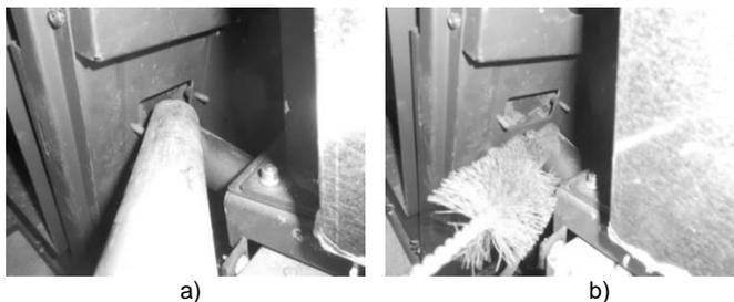
**Figura 107 - a) Aspirar el interior; b) Limpiar con escobillón**
