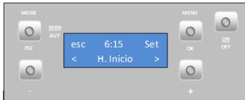
Para seleccionar la **hora de parada** en el programa P1, pulse "Set" (configurar) y comenzará a parpadear. A continuación, pulse la tecla "+" o "-" para seleccionar la hora deseada y pulse "OK" (aceptar) para confirmar el valor. Pulse la tecla "+" para pasar al menú "P1 Temp. Ar".
