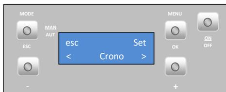
Los programas se pueden definir de dos maneras diferentes, a través del menú "Carga Perfil" o a través del programador diario P1 a P6 (**sólo una opción puede estar activa, no funcionan simultáneamente**).
