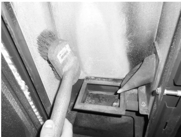
**Figura 104 - Limpieza de la vermiculita**
