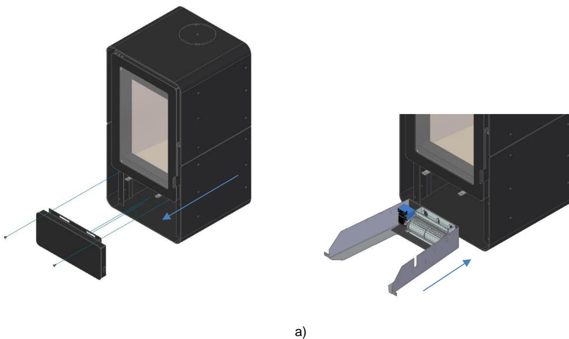
\* Passar a cablagem pelo furo e apertar o passa-cabos (figura 39-b)
