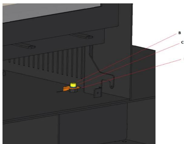
Fig. 25 – Colocação e aperto do fixador à salamandra
