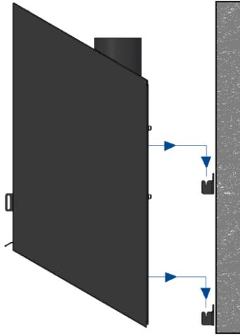
Fig. 28 – Posicionamento da salamandra nos apoios de parede
