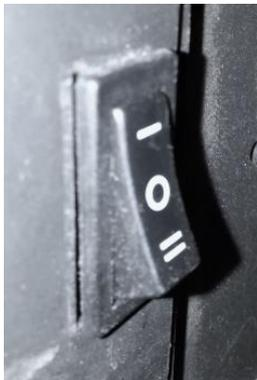
**Posição I** – Ventilador activa-se automaticamente com um caudal de 60m<sup>3</sup>/h quando o termostato atingir os 50°C.
