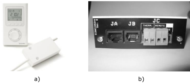
Figura 145 – Mando externo (cronotermostato) e interfaz de conexión – ambos no incluidos
