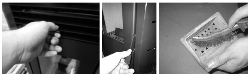
a) b) c) Figura 136 – Barra de limpieza y cierre de la puerta
