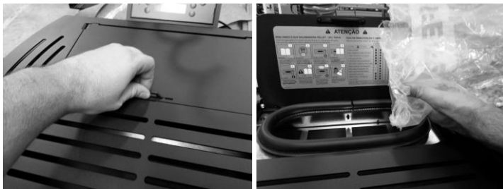
Figura 133 - Reabastecimiento del depósito de pellets
