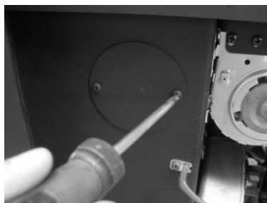
Figura 139 – Ejemplo K100 a) Retirar los tornillos; b) Retirar la tapa
