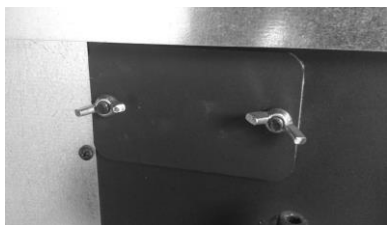
Figura 140 – Ejemplo K300, K400 y K500 a) Retirar las tuercas de mariposa; b) Retirar la tapa
