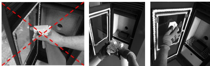
a) b) c) Figura 135 – Limpieza de vidrio: a) aplicar líquido en el paño; b) limpiar el vidrio con el paño c)
