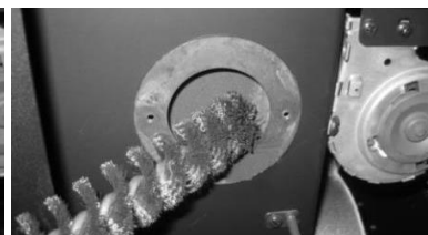
Figura 141 – Ejemplo K100 a) Aspirar el interior; b) Limpiar con escobillón
