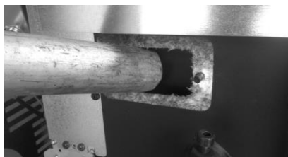
Figura 142 – Ejemplo K300, K400 a) Aspirar el interior; b) Limpiar con escobillón
