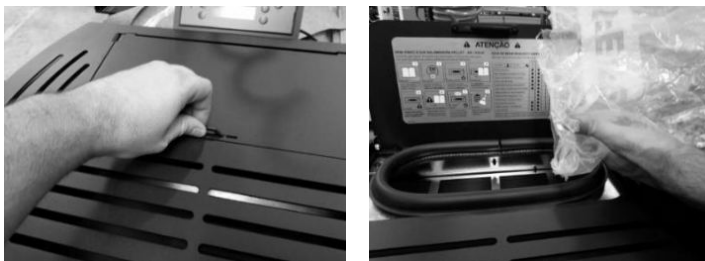
Figure 133 - Ouverture du couvercle du réservoir à granulés
