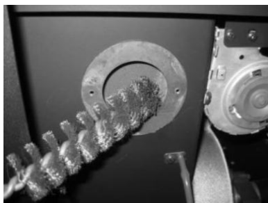
Figure 141 – Exemple K100 a) Aspirez l'intérieur ; b) Nettoyez avec un écouvillon
