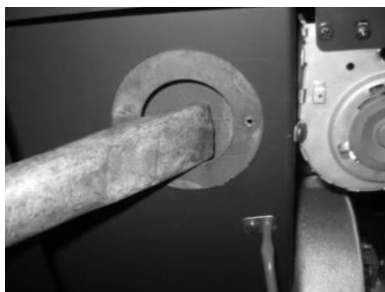
Figure 141 – Exemple K100 a) Aspirez l'intérieur ; b) Nettoyez avec un écouvillon
