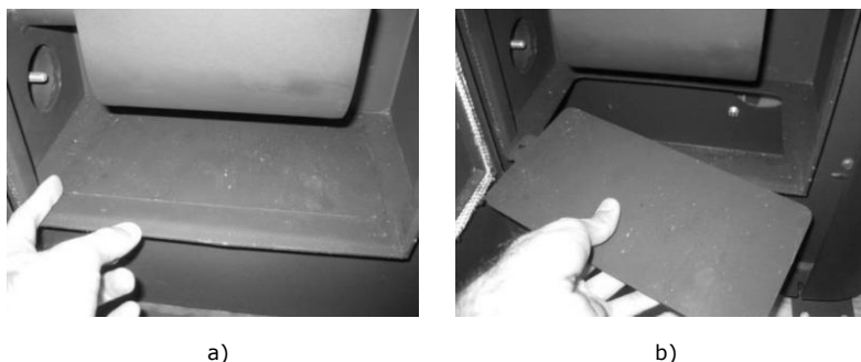
Figure 138 - Nettoyage de l'intérieur du poêle
