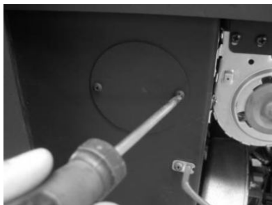
Figure 139 – Exemple K100 a) Retirez les vis ; b) Retirez le couvercle
