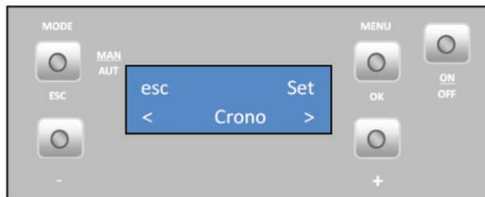
Para **activar el modo Crono**, pulse "Set" (configurar) y comenzará a parpadear. A continuación, pulse la tecla "+" o "-" para seleccionar "On" (activar) u "Off" (desactivar), y pulse "Ok" (aceptar) para confirmar la selección. Pulse la tecla "+" para pasar al menú "Carga perfil".
