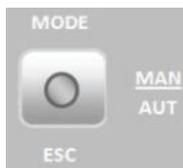
a) Botón para cambiar de modo manual, automático y para salir de los menús (ESC).
