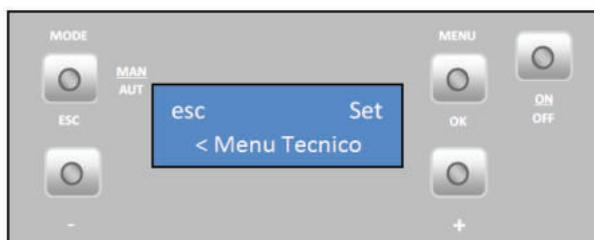
Pulse OK y comienza a parpadear "A", con el "+" y "-" teclas seleccionar la letra deseada, pulse OK para confirmar y "00" comenzará a parpadear, con el signo "+" y "-" botones seleccionan el número deseado, confirme bien y entrar en el menú "configuración general".
