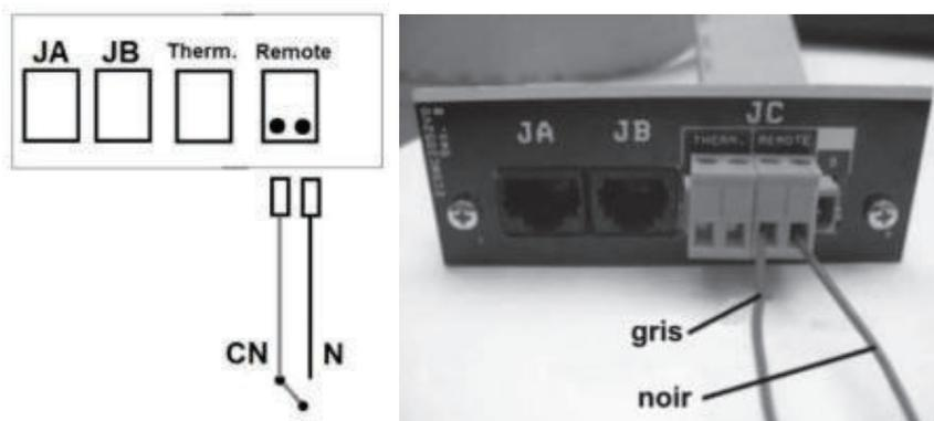
**Figure 146 - Branchement de la commande à distance filaire**
