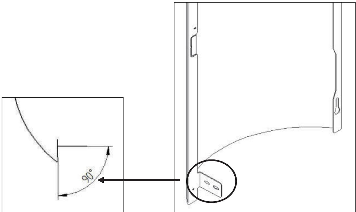
**Figure 75 - Angle de la languette inférieure**
