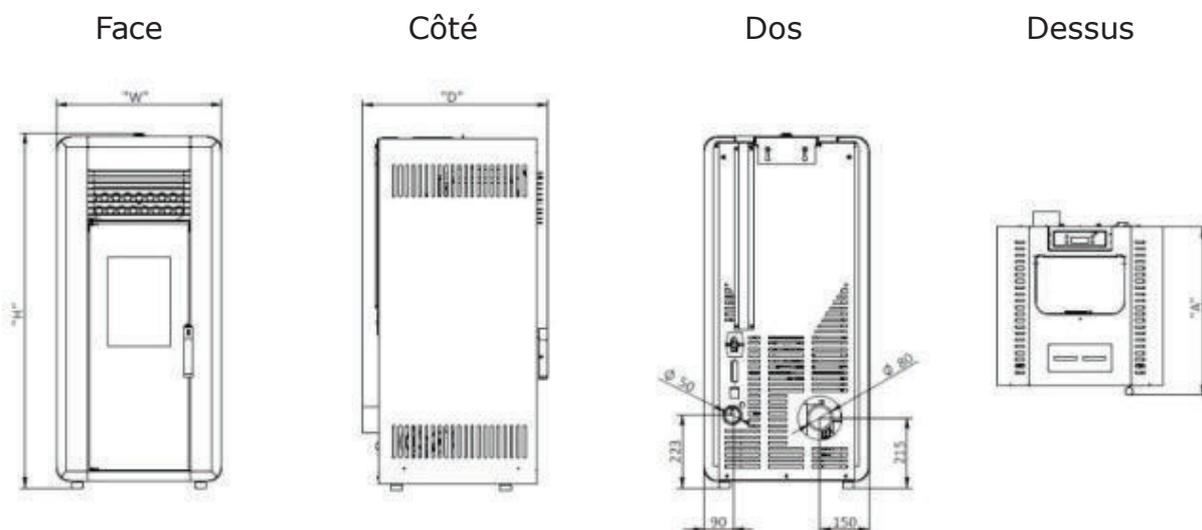
Figure 2-B – Dimensions poêles à granulés K300 et K400 (exemple modèle Leaf)
