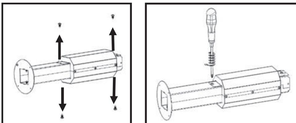
**Figure 117 - Démontage de l'isolation thermique**
