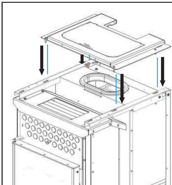
**Figure 83 - Installation du couvercle supérieur**
