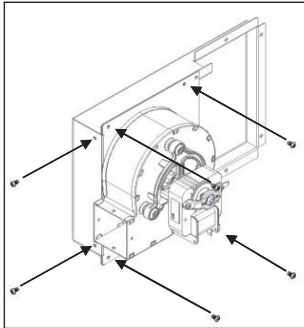
**Figure 124 - Support de fixation avec ventilateur**
