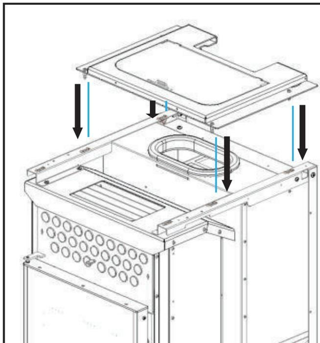
Figure 98 - Installation du couvercle supérieur
