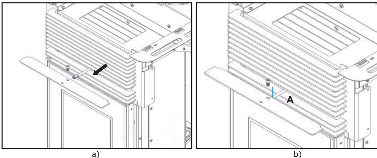
**Figure 92 - Fixation de la plaque mobile à la tige de nettoyage**
