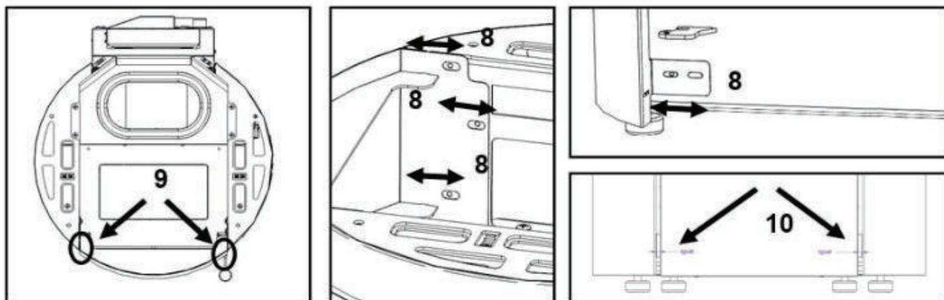
**Figure 80 - Réglage des boîtiers de l'équipement**
