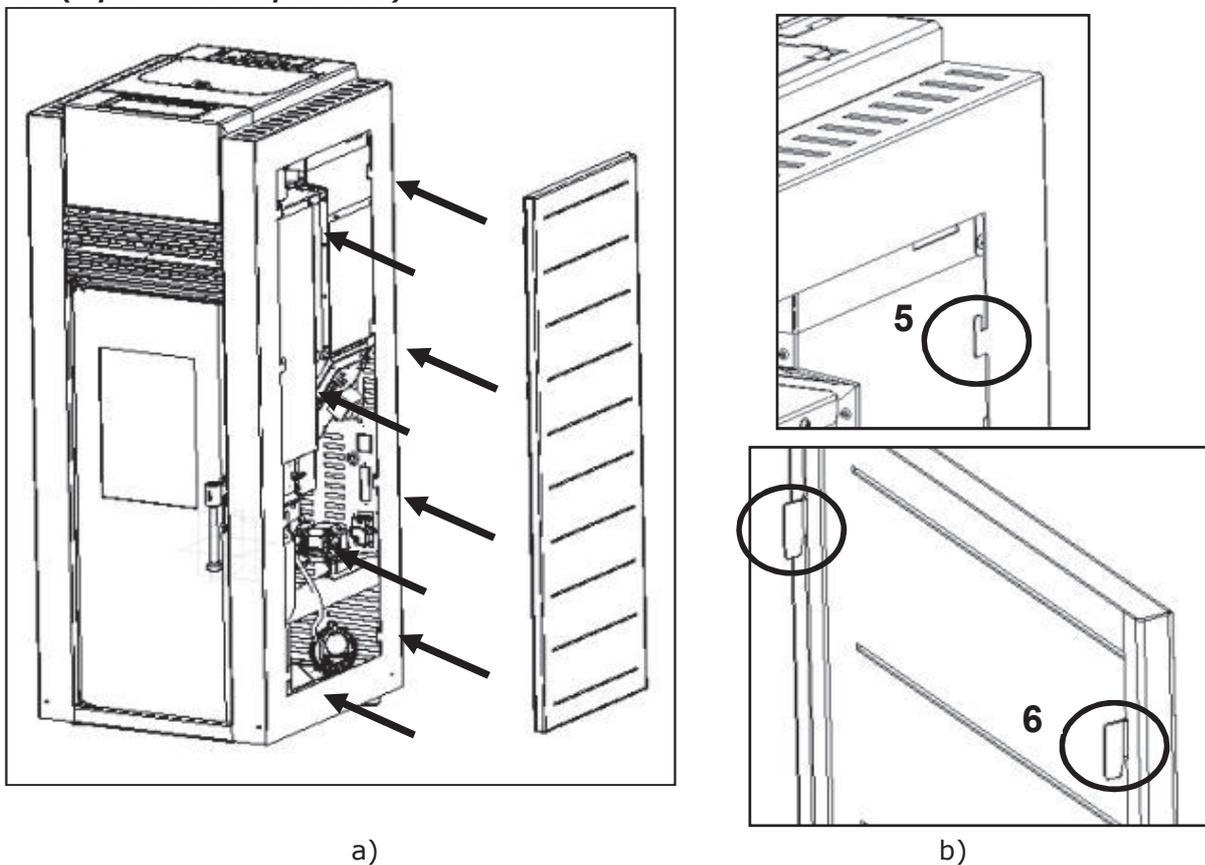
**Figure 65 - Fixation des finitions latérales**
