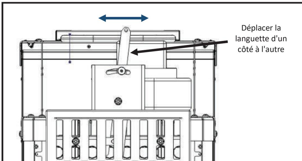
**Figure 116 - Vérifier le verrouillage du registre**
