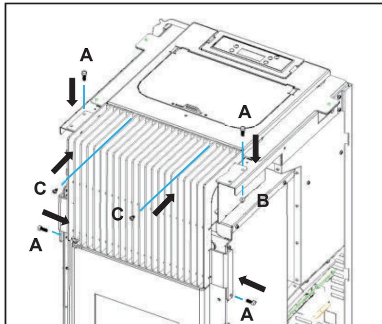
**Figure 34 - Installation de la grille avant**
