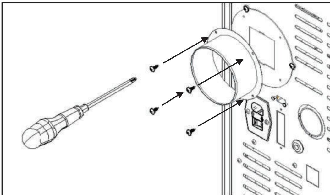
Figure 129 - Fixation de la sortie d'air de la bouche sur le pôle
