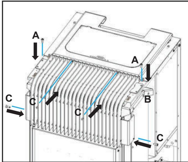
Figure 100 - Installation de la grille avant
