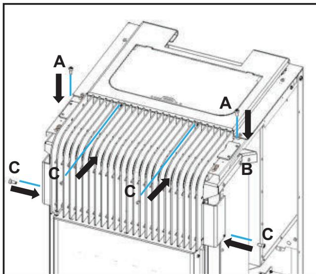
Figure 85 - Installation de la grille avant
