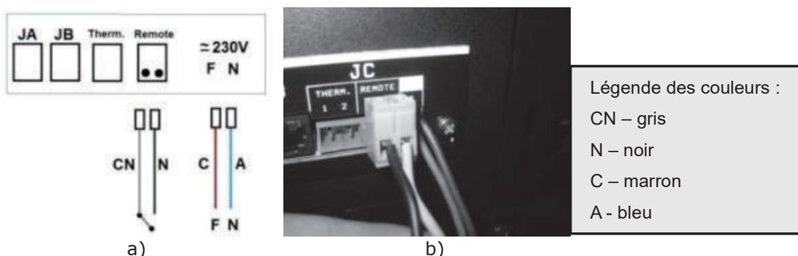
**Figure 145 - Branchement de la commande à distance sans fil**
