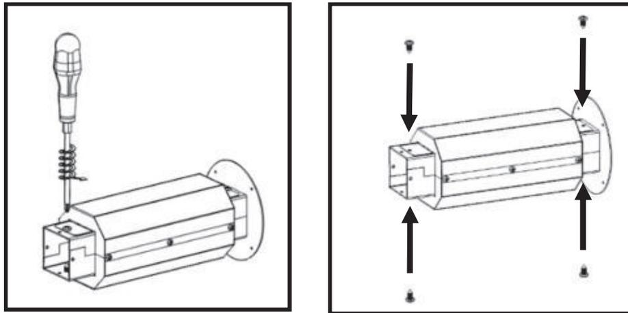
**Figure 119 - Remontage de l'isolation thermique**
