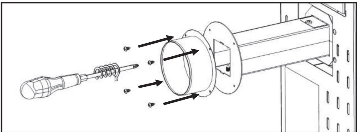
**Figure 113 - Fixation de la sortie d'air de la bouche sur le pôle**
