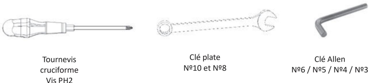
Figure 45 - Matériel nécessaire pour l'installation de l'habillage du poêle Alpes K400
