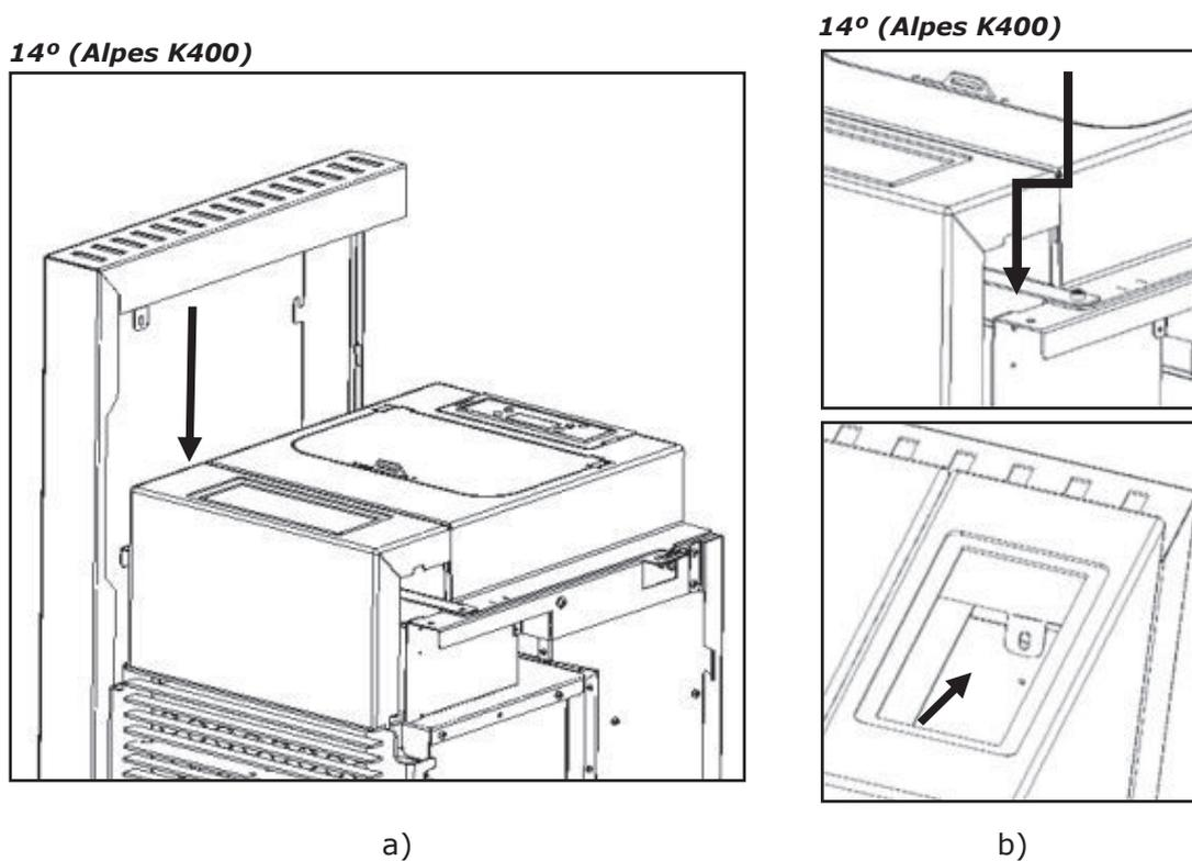
**Figure 63 - Les onglets sur les structures latérales**
