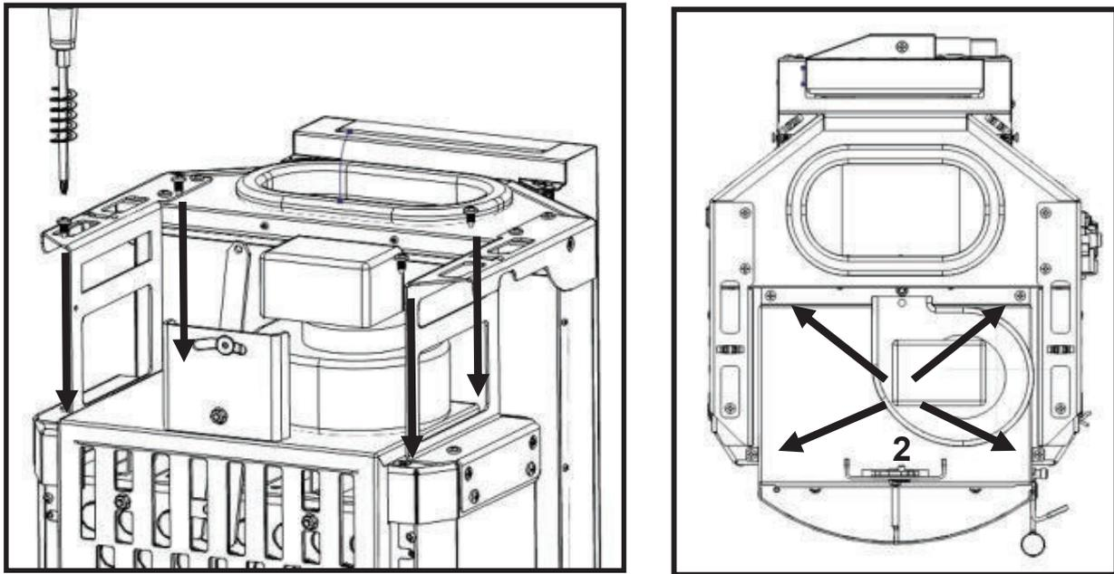
**Figure 109 - Fixation du ventilateur sur l'équipement**
