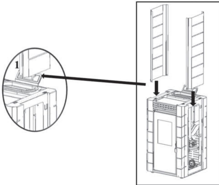
**Figure 24 - Mise en place des panneaux latéraux**
