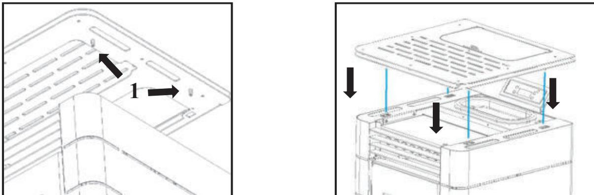
Figure 26 - Fixation du dessus
