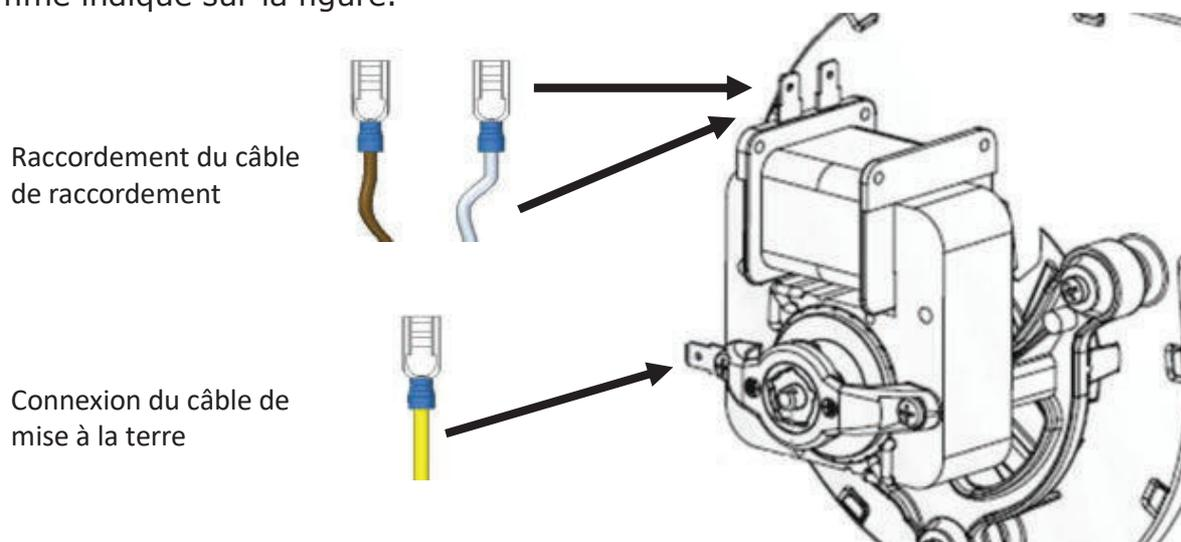
**Figure 115 - Raccordement électrique au ventilateur**
