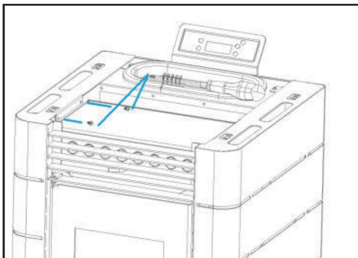
**Figure 22 - Fixation des panneaux latéraux à la partie supérieure**
