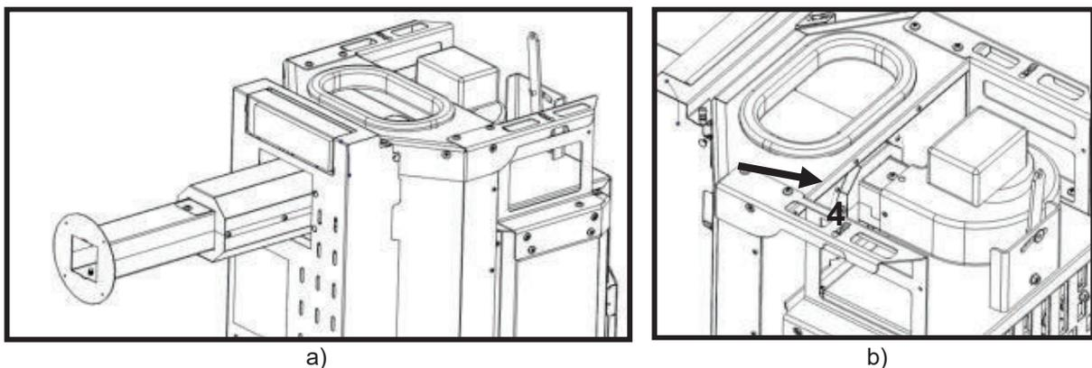
**Figure 111 - Montage du guide d'air sur le poêle**
