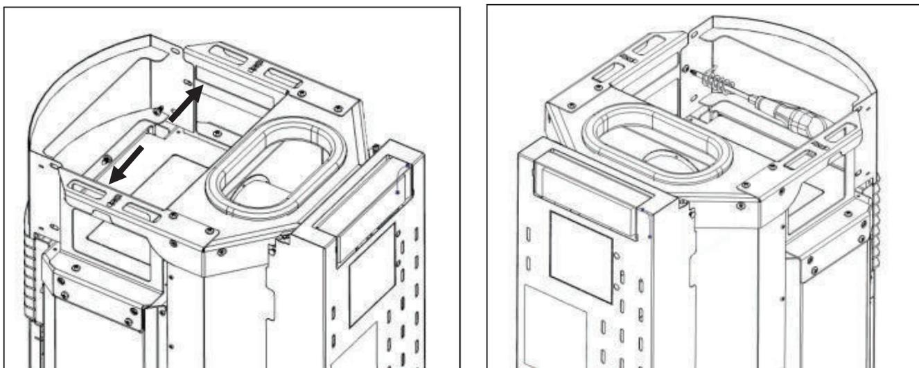
**Figure 73 - Fixation de la façade de finition**
