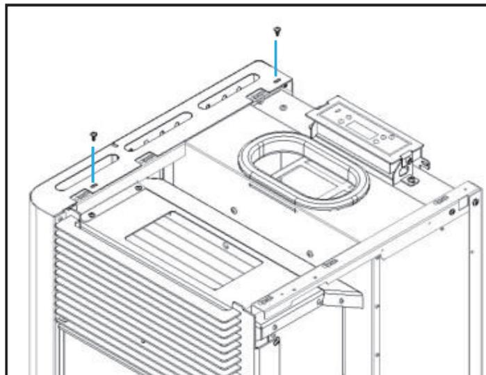
**Figure 95 - Fixation des panneaux latéraux à la partie supérieure**
