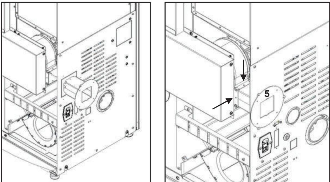
**Figure 127 - Montage du guide d'air sur le poêle**
