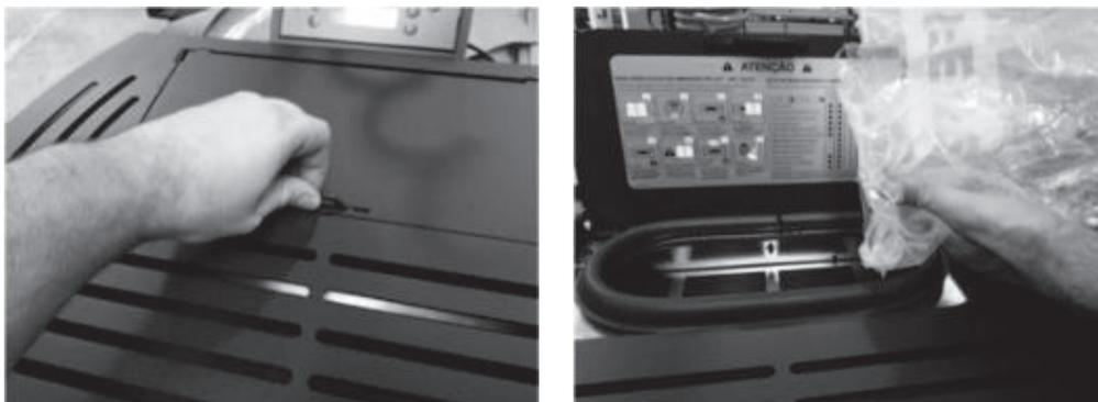
Figure 132 - Ouverture du couvercle du réservoir à granulés
