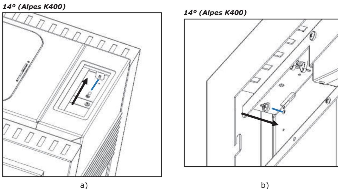
**Figure 64 A et B - Fixation des côtés structurels**
