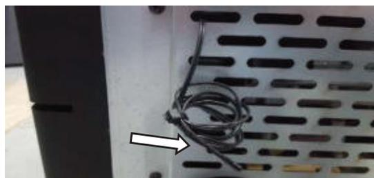
Figure 9 - Sonde de température ambiante
