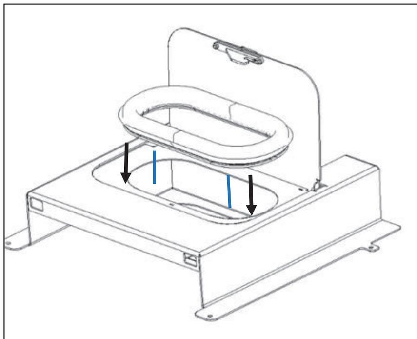
**Figure 50 - Mise en place du joint d'étanchéité en caoutchouc sur le couvercle supérieur**
