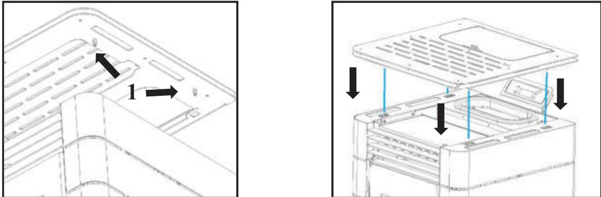
Figure 96 - Fixation du dessus
