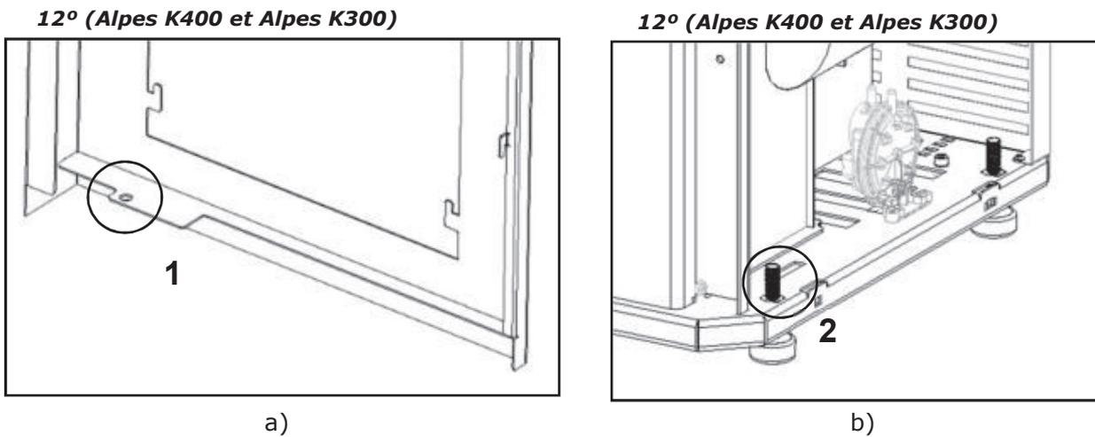
**Figure 61 - Emboîtement inférieur des structures latérales**
