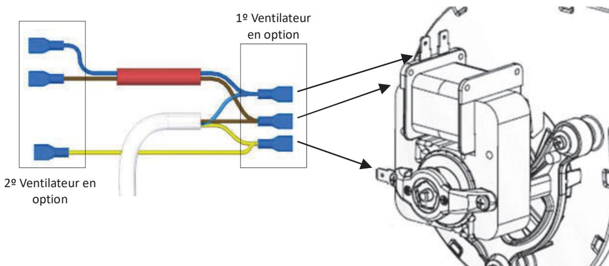
**Figure 131 - Raccordement électrique au ventilateur**
