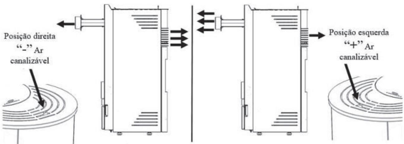
**Figure 120 - Réglage du registre d'air du tuyau "+" ou "-"**
