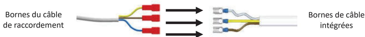
**Figure 130 - Raccordement du câble du ventilateur à l'appareil**
