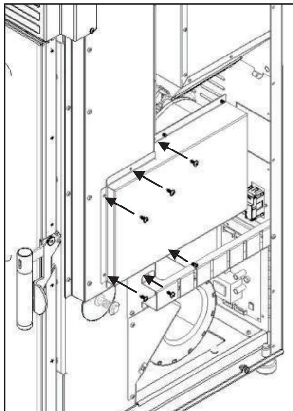
**Figure 125 - Fixation du ventilateur sur l'équipement**
