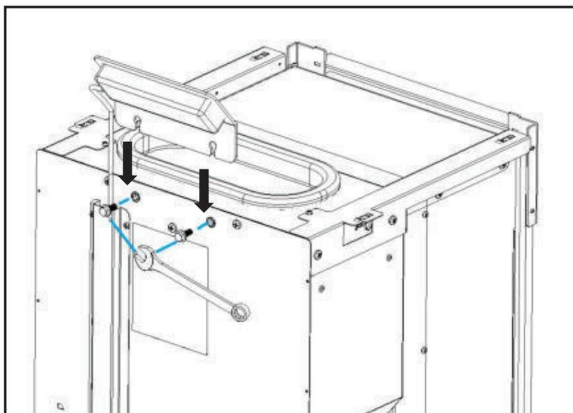
**Figure 19 - Mise en place de l'afficheur**
