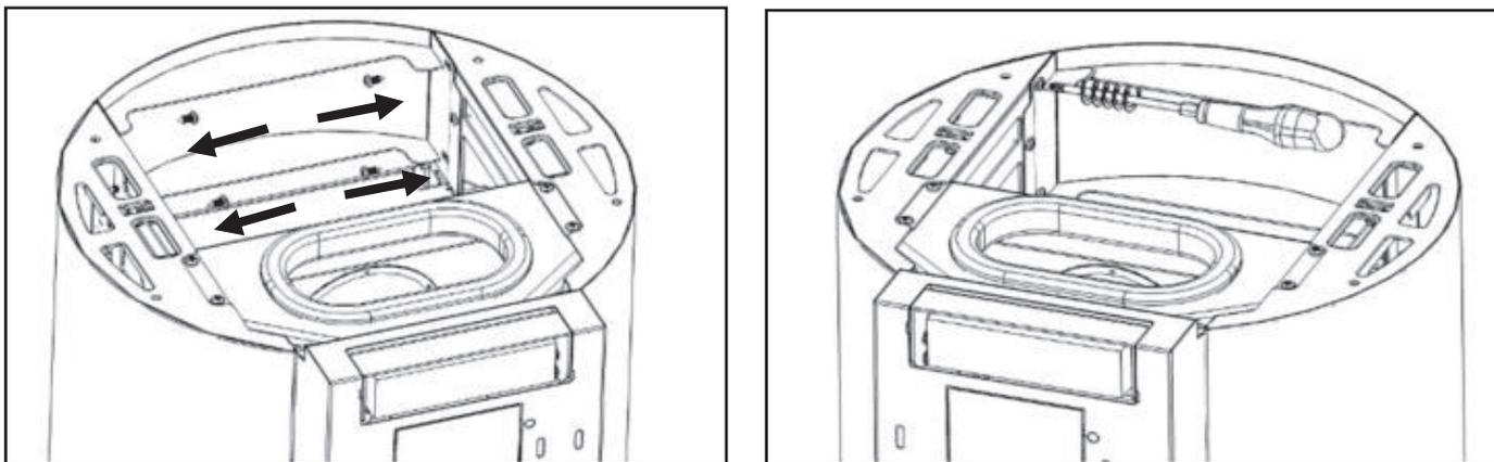
**Figure 78 - Fixation du couvercle à l'avant de la finition**
