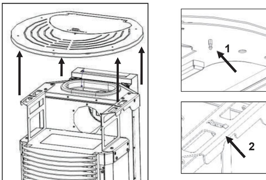
**Figure 71 - Démontage de la partie supérieure du K500**
