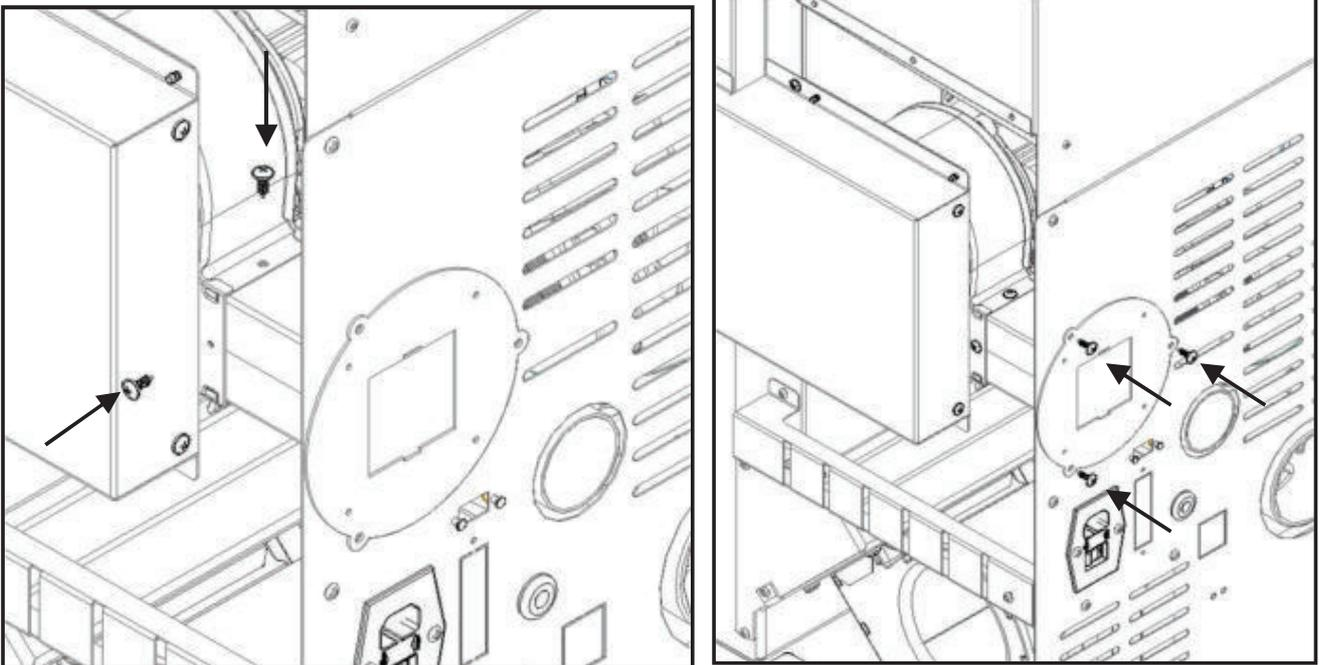
Figure 128 - Fixation du guide d'air sur le pôle
