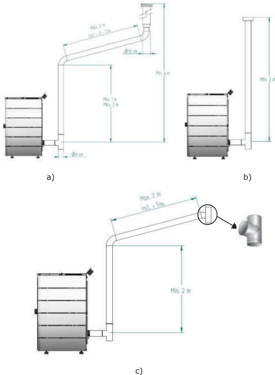
**Figure 6 - Exemples d'installations types**
