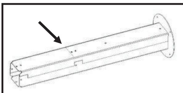
**Figure 118 - Zone de coupe de la partie "guide" de l'air de la tuyauterie**
