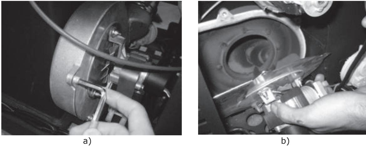
Figure 142 - a) Retirez les vis ; b) Retirez l'extracteur
