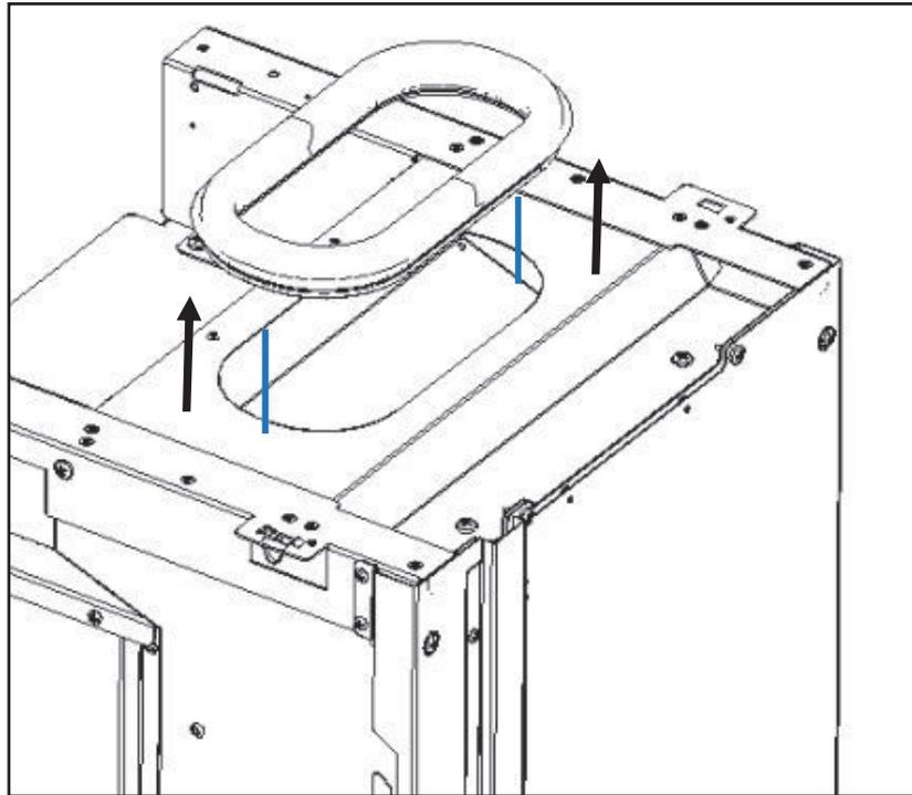
**Figure 49 - Enlèvement du joint en caoutchouc dans la machine**
