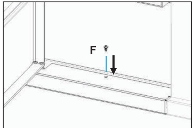
**Figure 43 - Fixation finition inférieure Olive**
