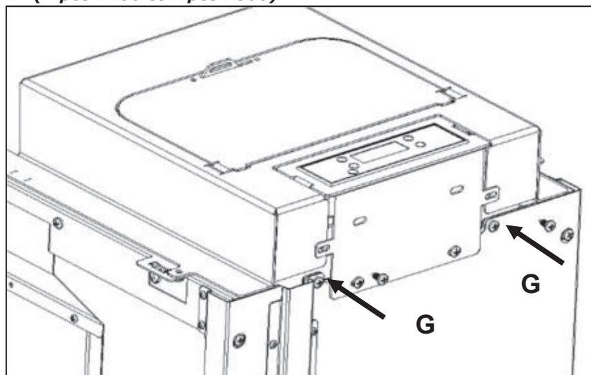
**Figure 54 - Placer le couvercle sur la structure de l'équipement**
