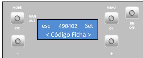
Le code logiciel / sécurité du firmware. En appuyant encore sur le bouton « + » on passe à « Code display ».
