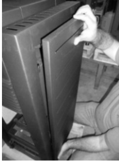
Figura 23 - Retirada de las tapas laterales
