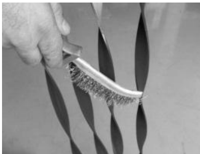
Figura 41 - Limpieza de los canales de paso de aire y turbuladores
