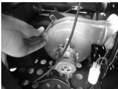
Figura 42 - a) Retirar los tornillos; b) Retirar el extractor
