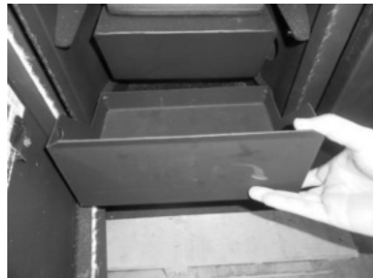
Figura 35 - a) Cestillo de quema; b) Cestillo de cenizas
