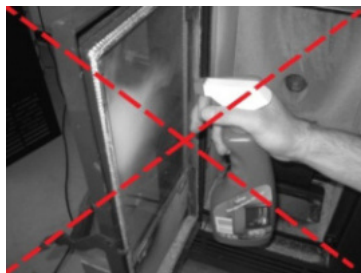
Figura 44 - Limpieza incorrecta del vidrio
