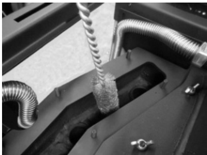
Figura 41 - Limpieza de los canales de paso de aire y turbuladores
