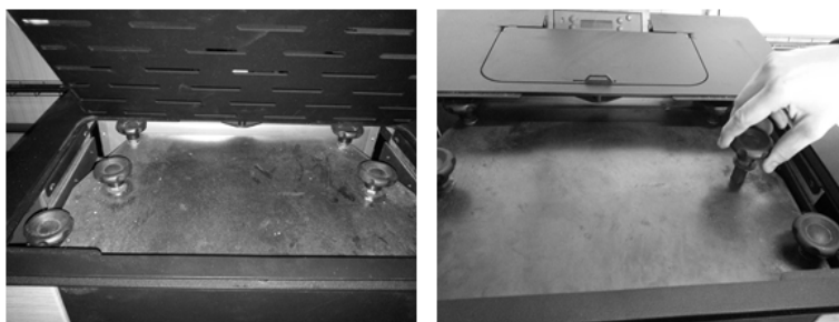
Figura 46 - Limpeza dos turbuladores
