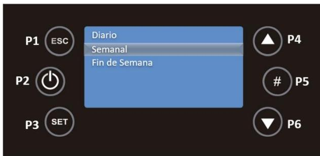
Debe pulsar P3 y este campo estará en modo editable, parpadeando. Pulse P4 y P6 para seleccionar el tiempo deseado y luego use la tecla P3 para guardar. Debe repetir este proceso durante el tiempo en que el dispositivo debe apagarse, usando las teclas P4 y P6. Finalmente debe activar el intervalo con la tecla P5, y aparecerá una marca de verificación en el lado derecho del intervalo.
