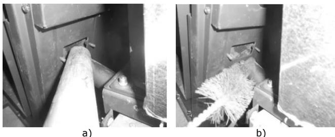
**Figura 109 - a) Aspirar el interior; b) Limpiar con escobillón**
