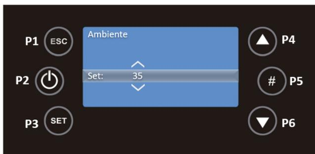
Presiona la tecla P3 para guardar los cambios y usa P1 para volver.
