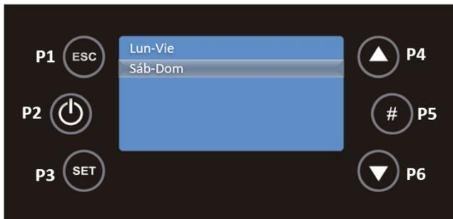
Debe pulsar P3 y este campo estará en modo editable, parpadeando. Pulse P4 y P6 para seleccionar el tiempo deseado y luego use la tecla P3 para guardar. Debe repetir este proceso durante el tiempo en que el dispositivo debe apagarse, usando las teclas P4 y P6. Finalmente debe activar el intervalo con la tecla P5, y aparecerá una marca de verificación en el lado derecho del intervalo.
