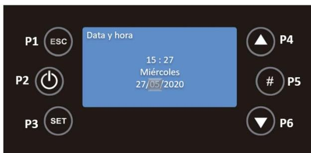
El Año sigue el mismo procedimiento, presione las teclas P4 y P6 para pasar al Año, use la tecla P3 para editar este campo, el año aparecerá en modo editable. Con P4 y P6 seleccione el año deseado y pulse P3 para validarlo.
