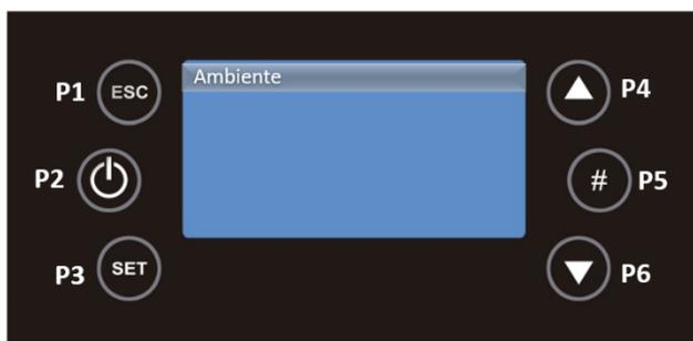
Puede fijar la temperatura de confort objetivo entre 10 y 40°C con las teclas P4 y P6.
