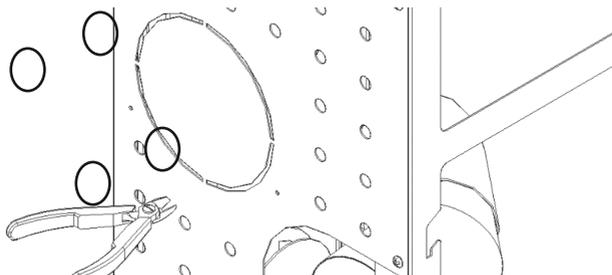
**Figura 60 - Retirada de la tapa posterior de la estufa**
