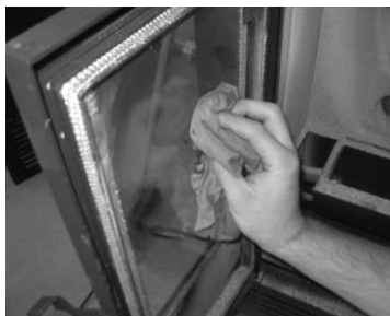
Figure 103 – Nettoyage vitre a) appliquer liquide ; b) nettoyage avec chiffon
