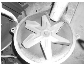
Figure 116 – a) Passer l'aspirateur sur la coque de l'extracteur ; b) Passer l'aspirateur sur l'extracteur
