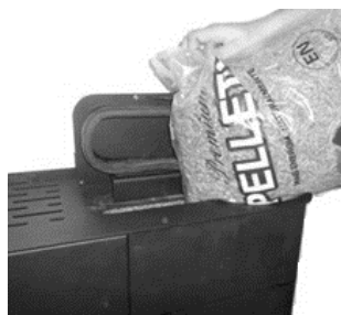
Figure 101 – Réapprovisionnement du réservoir de pellets
