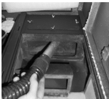
Figura 107 - Limpeza do interior da salamandra
