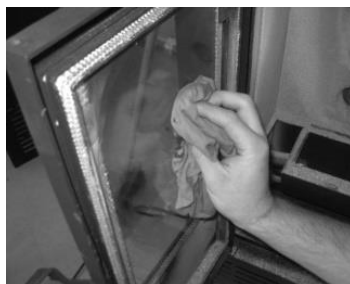
Figura 103 - Limpeza do vidro: a) aplicar líquido no pano; b) limpar o vidro com o pano
