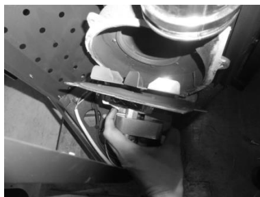
Figura 115 - a) Retirar os parafusos; b) Retirar extrator
