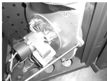
Figura 115 - a) Retirar os parafusos; b) Retirar extrator
