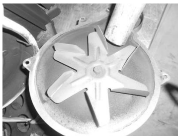
Figura 116 - a) Aspirar a concha do extrator; b) Aspirar o extrator
