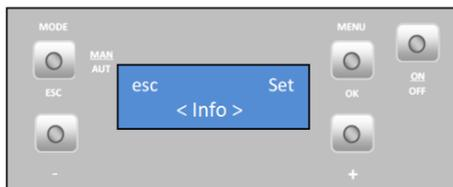
Code logiciel / firmware de la carte mère (carte électronique de l'appareil). En appuyant encore sur le bouton « + » on passe à « Code de sécurité ».
