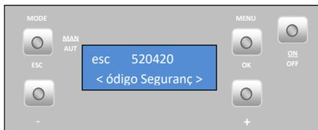
Code logiciel / firmware de l'afficheur. En appuyant encore sur le bouton « + » on passe à « Code param ».
