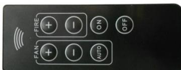
**Figure 107 – Commande infrarouge du poêle**
