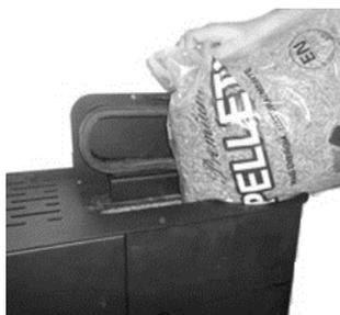
**Figure 111 – Réapprovisionnement du réservoir de pellets**
