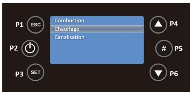
Avec les touches P4 et P6, vous pouvez modifier la puissance de combustion du système. Ce sous-menu permet de modifier la puissance de ventilation du système. Il peut être réglé en mode automatique ou manuel : dans le second cas, l'utilisateur sélectionne la puissance de 0 à 5.
