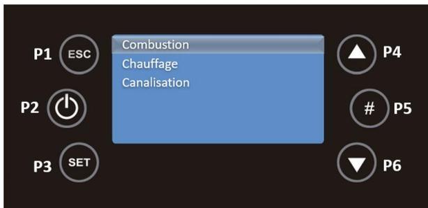
Les touches P4 et P6 permettent de modifier la puissance de combustion du système. Il peut être réglé en mode automatique ou manuel : dans le premier cas, le système choisit la puissance de combustion ; dans le second cas, l'utilisateur sélectionne la puissance de 0 à 5.
