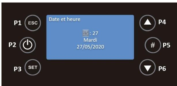
La même chose doit être faite pour les minutes, avec P6 sélectionnez Minutes et appuyez sur P3, les minutes apparaîtront en mode modifiable, clignotant, avec P4 et P6 sélectionnez les bonnes minutes et appuyez sur P3 pour valider.
