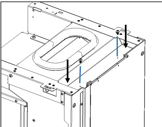
**Figura 48 - Colocação dos parafusos na cuba de pellets**
