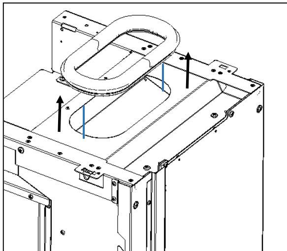
**Figura 49 - Remoção da borracha de vedação no equipamento**
