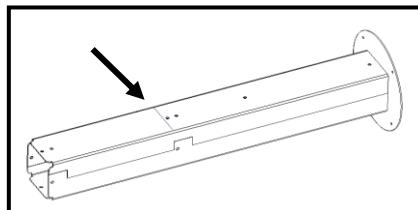
Figura 118 – Zona de corte da peça “guia” do ar canalizável
