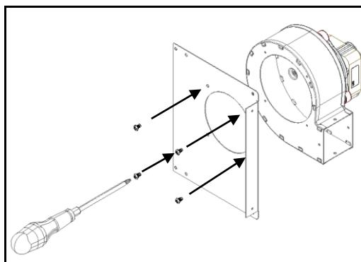
Figura 123 - Fixação apoio com o ventilador
