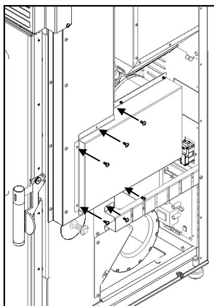
Figura 125 - Fixação do ventilador na salamandra
