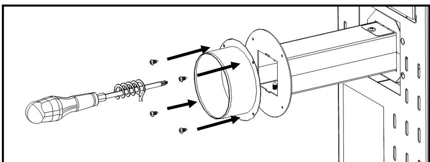
Figura 113 – Fixação boca saída de ar na salamandra
