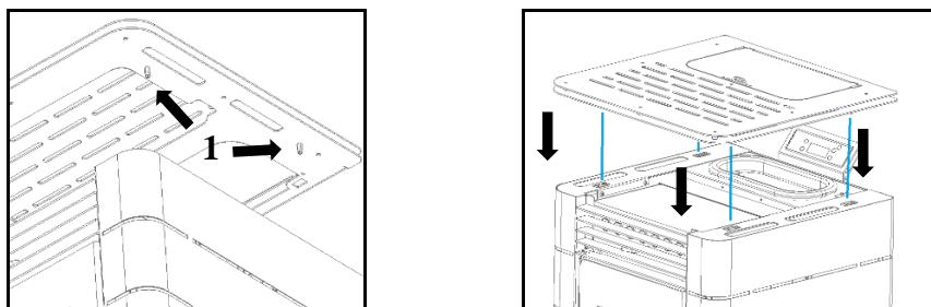
Figura 96 – Fixação do tampo
