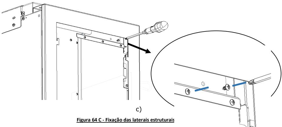
Figura 64 C - Fixação das laterais estruturais
