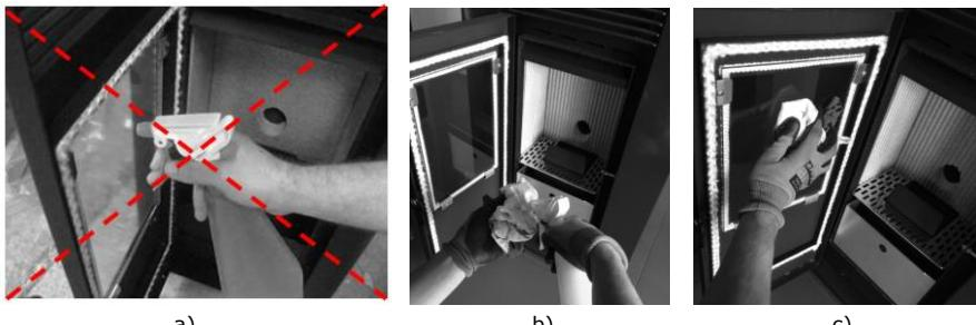
Figura 134 – Limpeza do vidro: a) limpeza incorreta do vidro; b) aplicar líquido no pano; c) limpar o vidro com o pano
