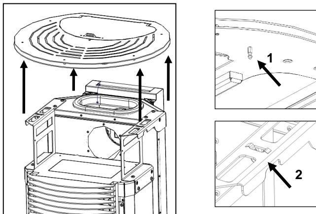
**Figura 71 - Remoção do tampo da K500**
