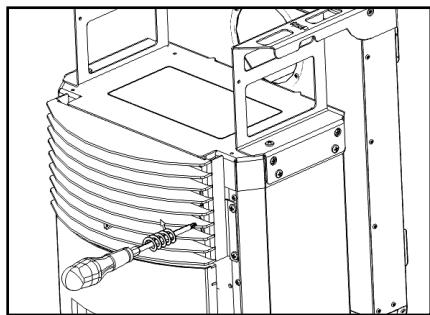
**Figura 105 – Remoção da grelha lateral**
