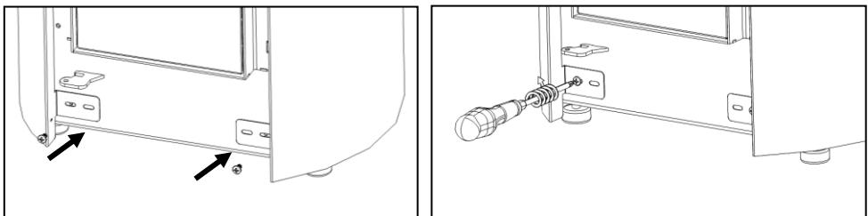
Figura 79 - Fixação da capa ao frontal do equipamento
