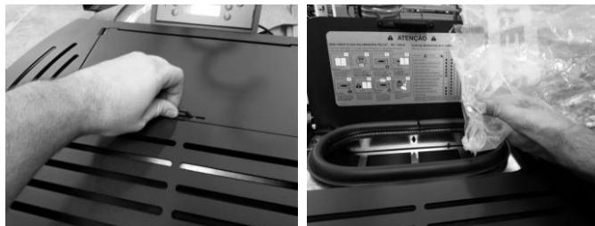
**Figura 132 – Abastecimento do deposito de pellets**
