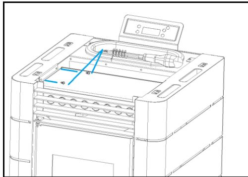
Figura 22 - Fixação das envelopantes laterais na parte superior
