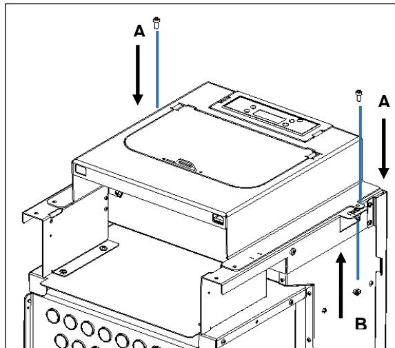
Figura 53 - Fixação do tampo na estrutura do equipamento
