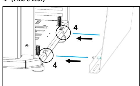
Figura 38 – Fixação das envolventes Pine e Leaf
