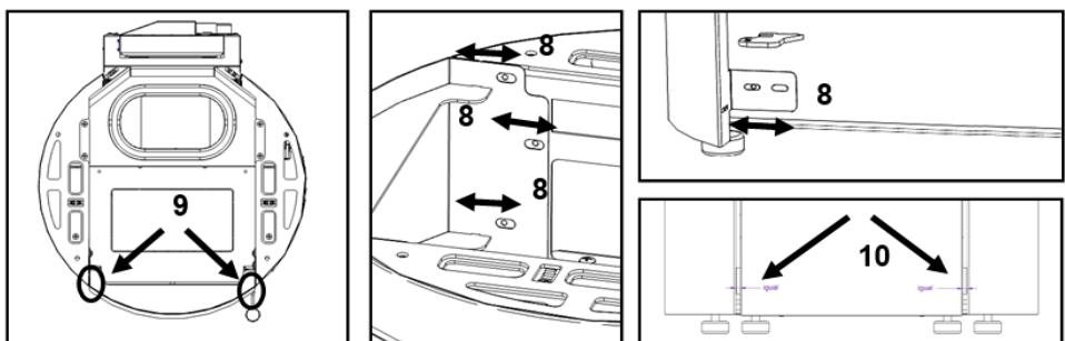
Figura 80 - Afinação das envolventes no equipamento
