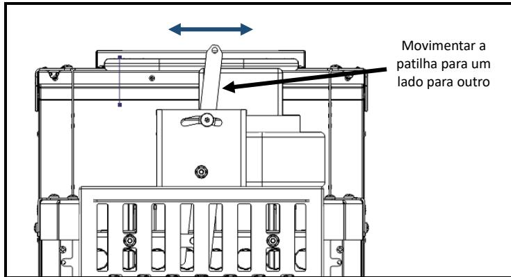
Figura 116 – Verificar o bloqueio do registo
