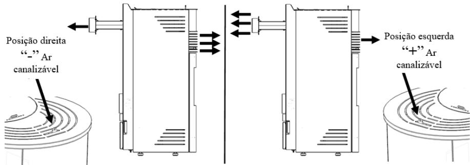
Figura 120 – Regulação do registo do Ar canalizável "+" ou "-"
