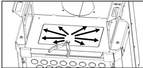
Figura 106 – Remoção tampa superior
