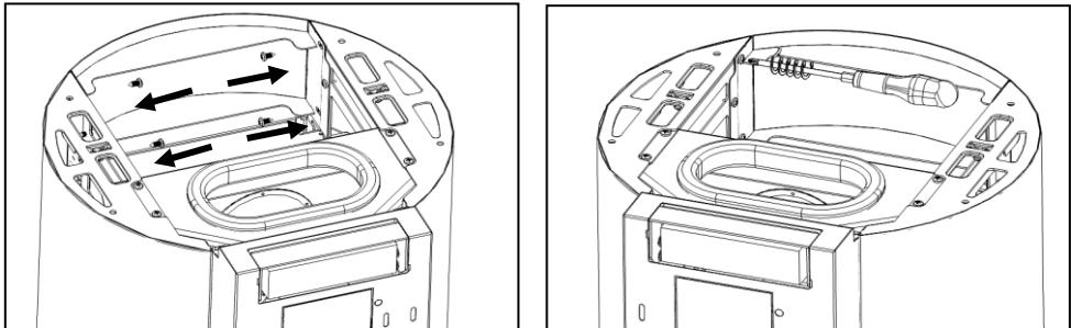
Figura 78 - Fixação da capa ao frontal de acabamento
