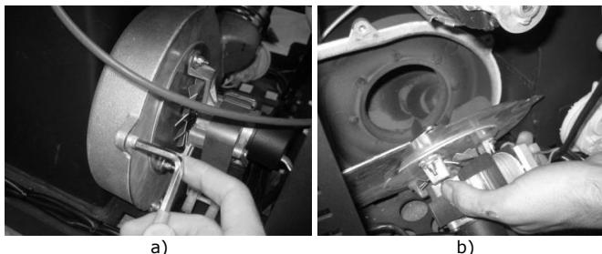
**Figura 142 – a) Retirar os parafusos; b) Retirar extrator**
