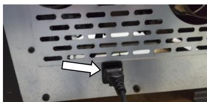
Figura 8 - Ficha ligação corrente elétrica
