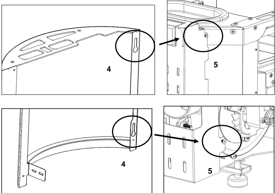
Figura 76 - Encaixe da capa lateral
