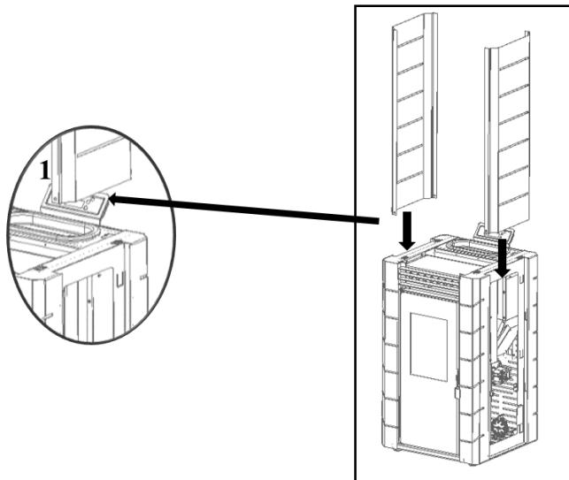
Figura 24 - Colocação envolventes laterais
