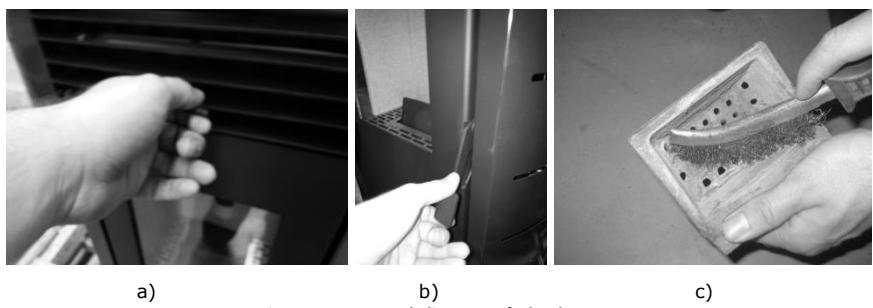
Figura 135 – Barra de limpeza e fecho da porta
