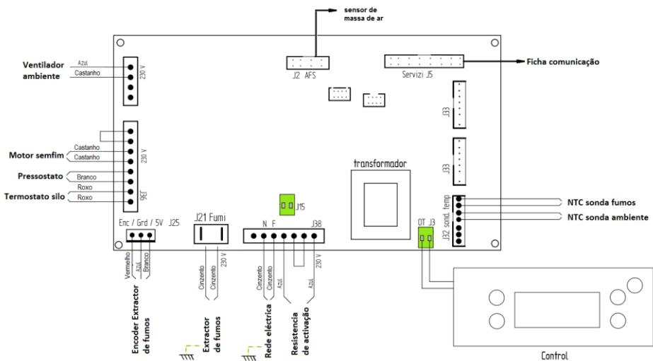
Figura 150 – Esquema elétrico Salamandras K300 e K400
