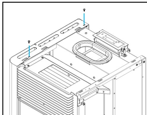
Figura 95 – Fixação das capas laterais na parte superior
