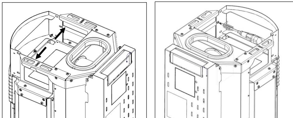
**Figura 73 - Fixação do frontal de acabamento**
