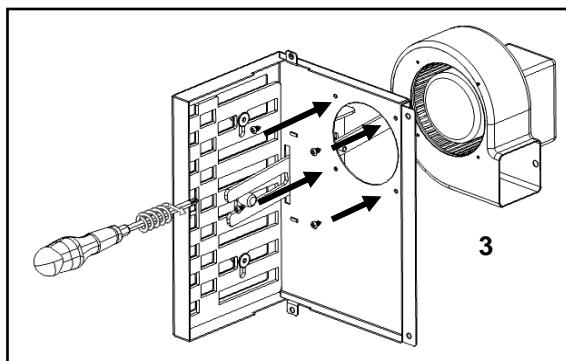
Figura 108 – Fixação apoio com o ventilador
