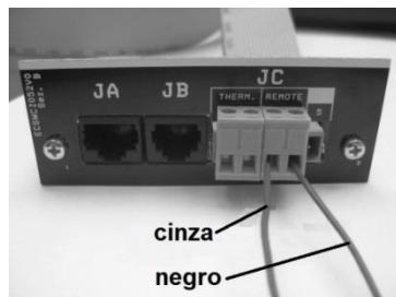
Figura 146 – Ligações do comando externo com fios
