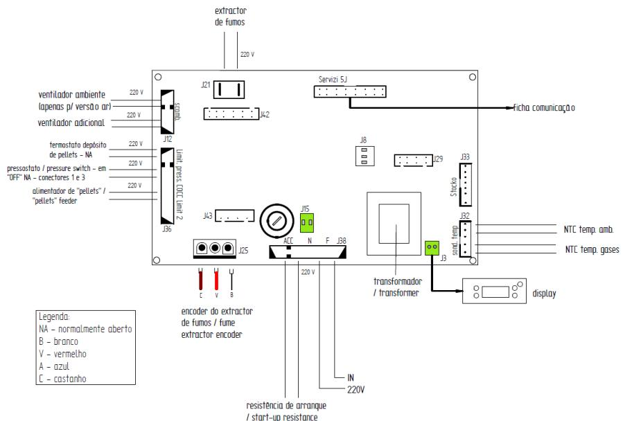
Figura 149 – Esquema elétrico Salamandra K100, K500 e K600
