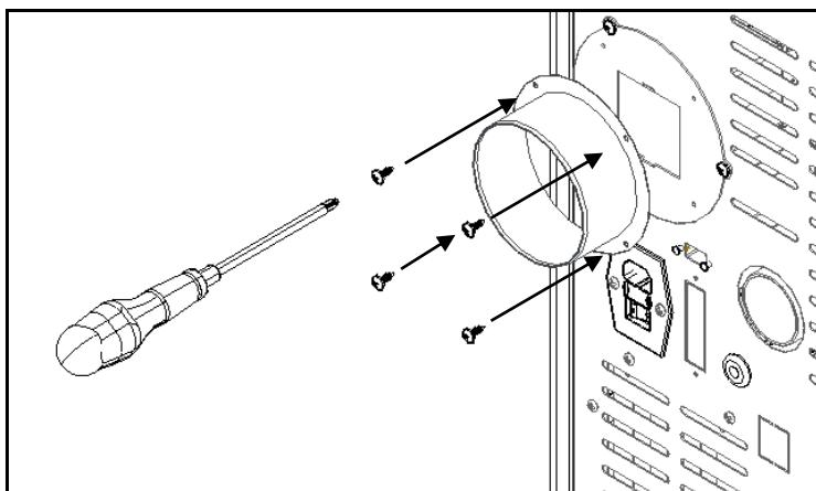
Figura 129 - Fixação boca saída de ar na salamandra
