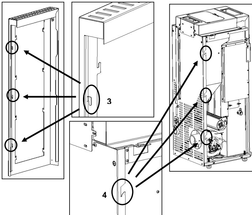
**Figura 62 - Encaixe lateral das estruturas laterais**
