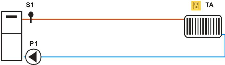
Figure 41 - Connexion simple juste aux radiateurs de chauffage central
