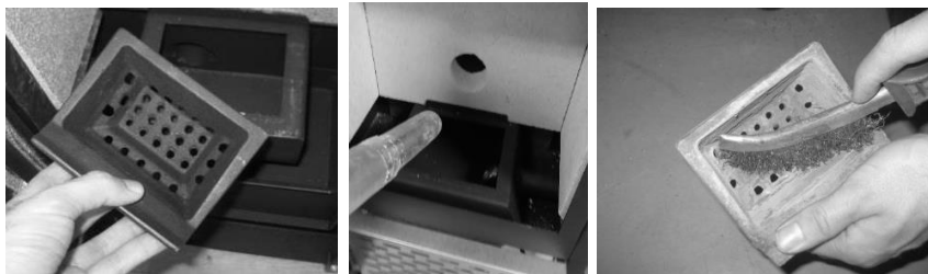
a) Remoção queimador b) Limpeza interior c) Limpeza queimador
