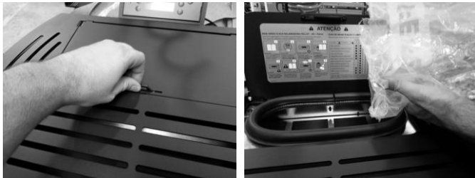
Figura 17 – Abastecimento do depósito de pellets
