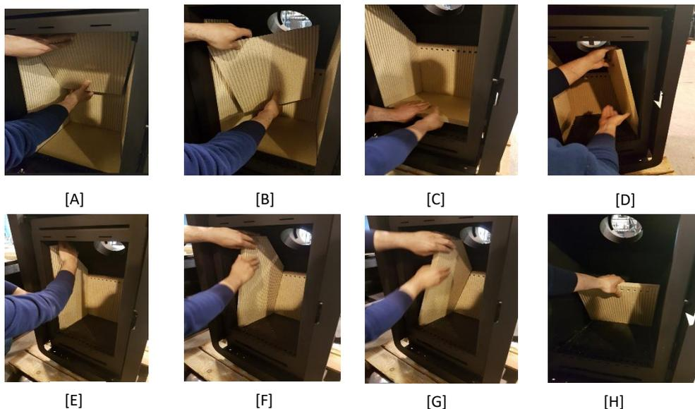
**Figura 31 - Sequência que deve ser seguida para retirar o deflector de fumos e as restantes vermiculites**
