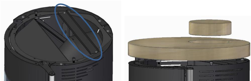
**Figura 14 - Colocação do tampo em pedra no equipamento com saída de fumos na horizontal**
