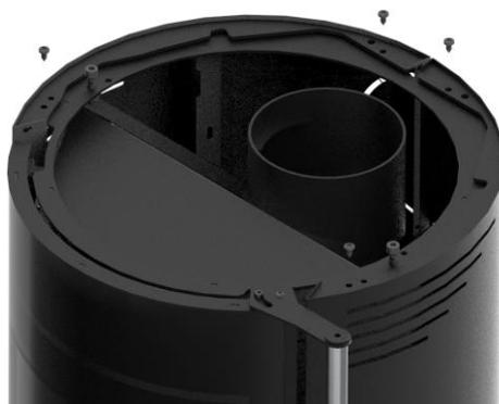
**Figura 19 - Montagem das capas laterais no equipamento**
