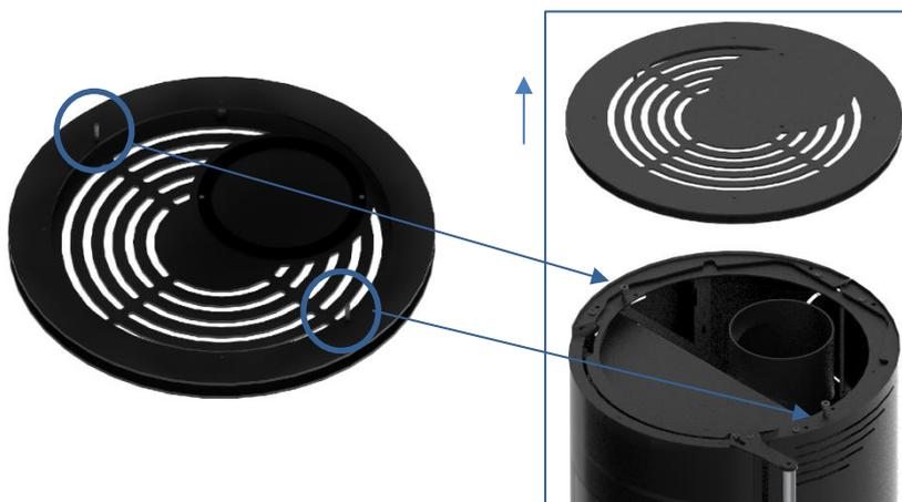
**Figura 15 - Desmontagem do tampo no equipamento**
