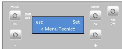
Carregar em Ok e começa a piscar "A", com as teclas "+" e "-" seleccione a letra pretendida, carregue em ok para confirmar e "00" começará a piscar, com as tecla "+" e "-" seleccione o nº pretendido, confirme em ok e entra no menu "Configuração".
