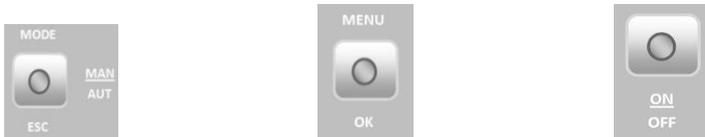
a) Tecla para mudar de modo manual, automático e para sair dos menus (esc).
