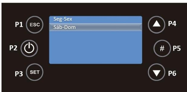
Deve pressionar P3 e este campo passa a estar no modo editável, a piscar. Pressionando P4 e P6 seleccione a hora desejada e de seguida use a tecla P3 para salvar. Deve repetir este processo para a hora em que o equipamento deve desligar, com as teclas P4 e P6. Por fim deve activar o intervalo com a tecla P5, e assim aparecerá um sinal de visto do lado direito do intervalo.
