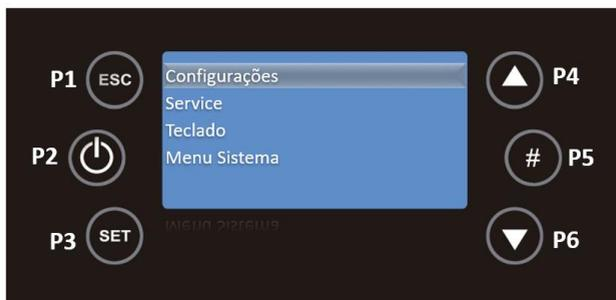
Com a tecla P6 selecciono o submenu Verão-Inverno e para validar a entrada neste submenu a tecla P3.
