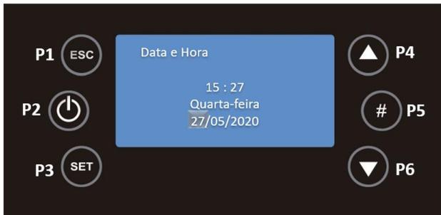
Para editar o Mês deve usar as teclas P4 e P6 para seleccionar este campo e de seguida P3, aparecerá o mês em modo editável, com P4 e P6 selecionar o mês desejado e voltar a pressionar P3 para validar.
