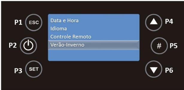
Pressionando as teclas P4 e P6, pode escolher entre o modo Verão ou Inverno, este Menu permite modificar o funcionamento da central hidráulica em função da estação do ano. Use a tecla P3 para validar a escolha.
