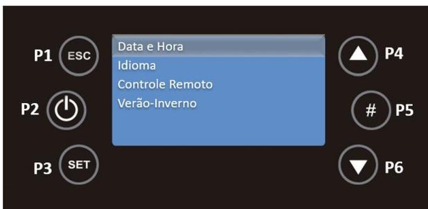
Já no menu Data e Hora, seleccionar Hora, com as teclas P4 e P6, e pressionar a tecla P3, aparecerá a hora em modo editável, a piscar, com P4 e P6 seleccionar a hora correta e pressionar P3 para validar.
