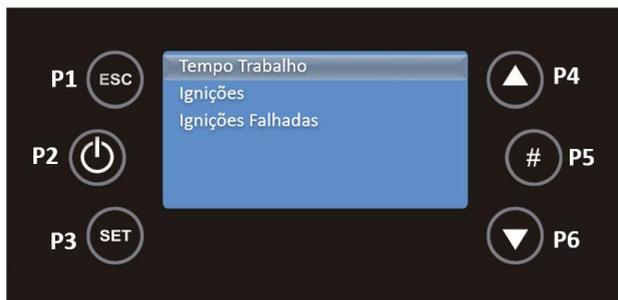
Com as teclas P4 e P6, seleccione o submenu que deseja consultar e pressione P3 para validar. Para voltar ao menu Service pressione P1.
